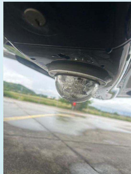
Poškození zábleskového majáku letounu na LKMH po střetu s kánětem
