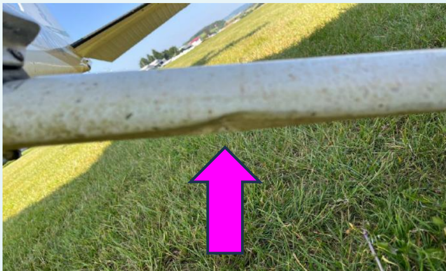
Poškození levé podvozkové nohy
